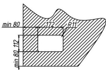
\*Пульт управления может врезаться в соседнюю столешницу (в один уровень) из ламината, а также в стену, соседний кухонный шкаф и т. п. Консультацию можно получить в отделе обработки заказов LIGRON.
